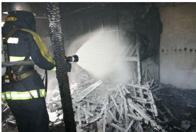
図 3. 建物火災を想定した消火実験
